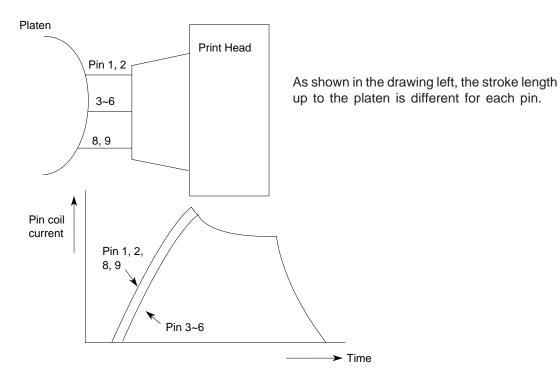
(d) Simultaneous Compensation of the number of impact pins
